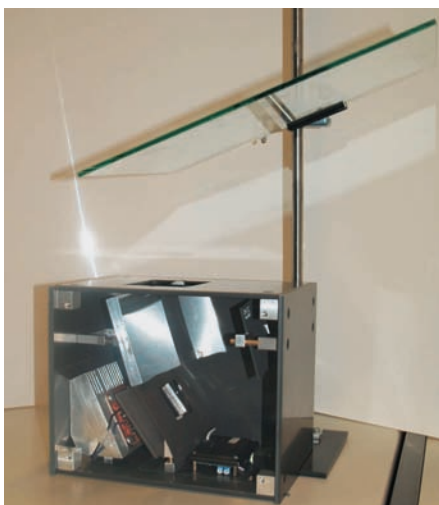
Bild 8: HUD-Demonstrator mit diamantgefrästem Abbildungsspiegel sowie Integration des Demonstrators in einen Fahrsimulator
