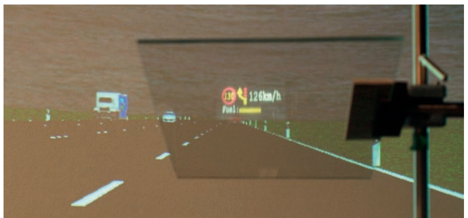
Bild 8: HUD-Demonstrator mit diamantgefrästem Abbildungsspiegel sowie Integration des Demonstrators in einen Fahrsimulator
